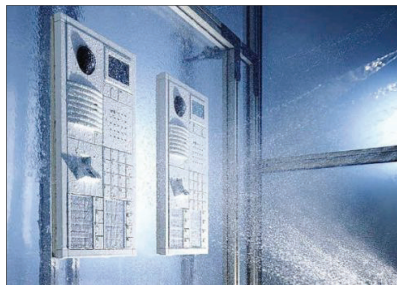
Die Beregnungsanlage simuliert möglichst realitätsnahe Witterungsbedingungen für Türsprechanlagen – und ist Marke Eigenbau.
