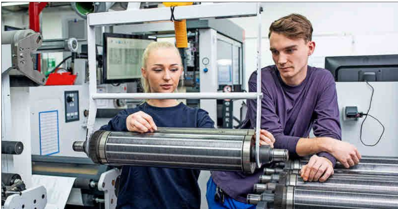
Auszubildende Medientechnologin misst unter Anleitung des Ausbilders den Stanzzylinder für das nächste Stanzblech aus. FOTO: FALLER PACKAGING / BRITT SCHILLING
